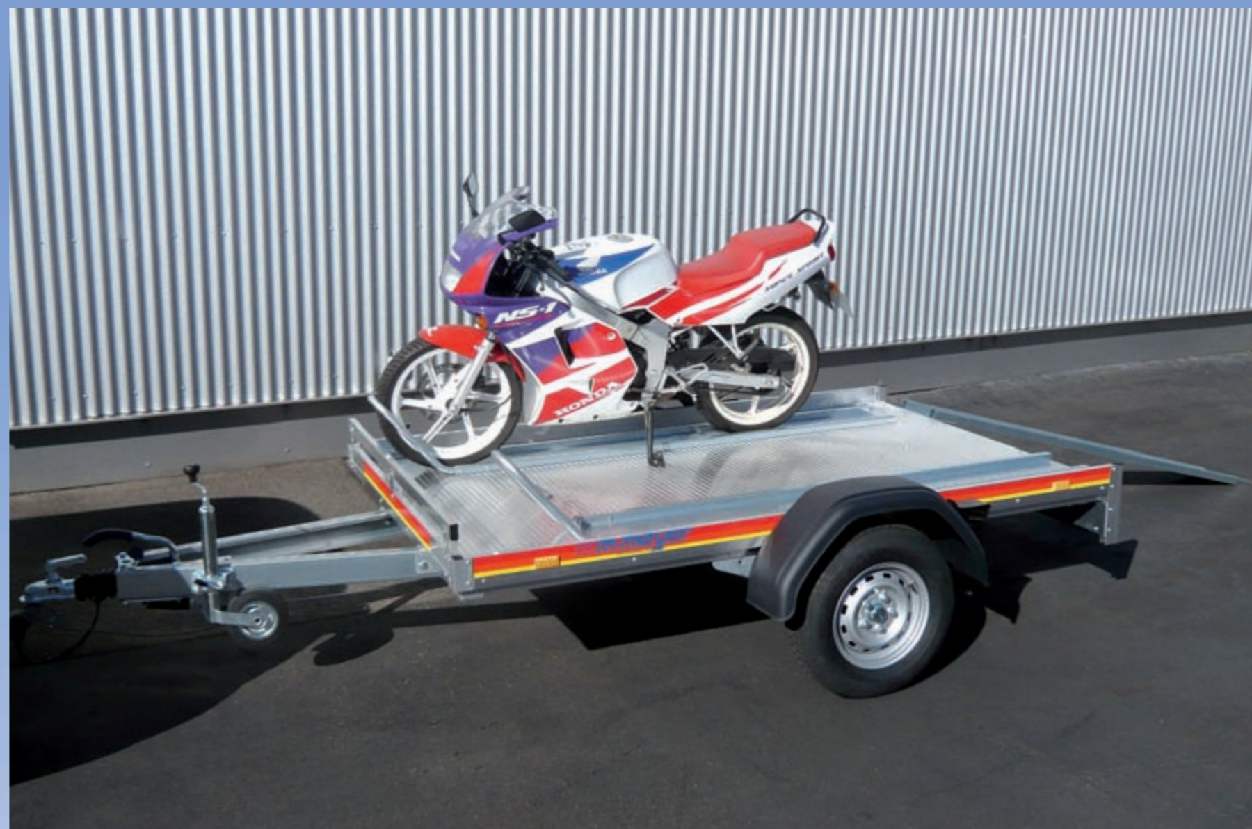
Mot 1025/151 Aluprofilboden geschlossen, 5 Zurringe auf Boden, Alubordwände 3seitig (Höhe: 100 mm) mit Querreling vorne (verschraubt)
